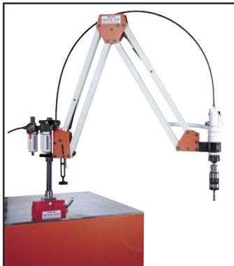
Soporte imantado colocado sobre una base metálica. Recuerde que ésta debe de tener un espesor de al menos 20 mm para asegurar la estabilidad del brazo.
