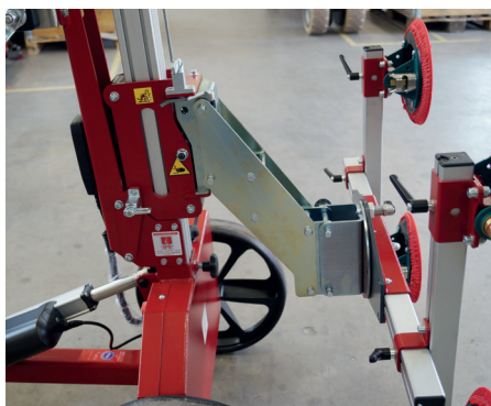
Die Verlängerung schräg nach unten ermöglicht eine Aufnahme von schmalen Scheiben
