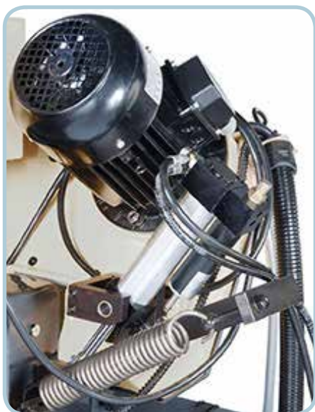
Bajada hidráulica (K-300-M-D/I-BH) Hydraulic descent (K-300-M-D/I-BH)
