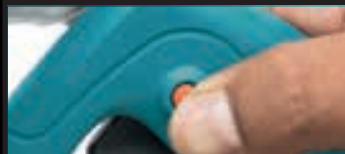
Interruptor de seguridad
