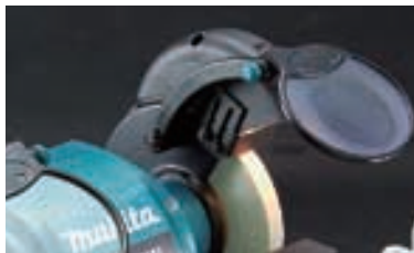
Función de aumento. Lupa de trabajo con un protector ocular para el trabajo cercano.
