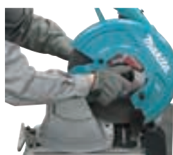
Cambio del disco abrasivo sin herramientas adicionales
