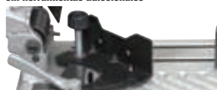
Ajuste de placa de guía sin herramientas adicionales
