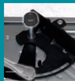
Ajuste rápido para una fijación de la pieza de trabajo.
