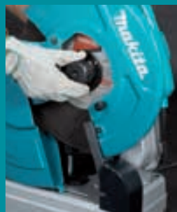
Fácil sustitución del disco de corte sin herramientas.
