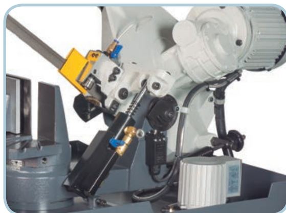
Bajada hidráulica (CY-270-N-BH) Hydraulic descent (CY-270-N-BH)
