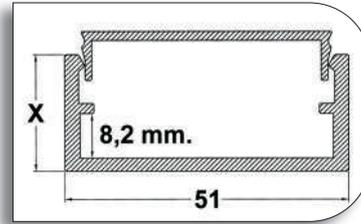
Sirven para tapar los Perfiles en "U" de 40x20 y de 51x21 más la Grapa o Tapeta, que se utilizan para barandillas y otros trabajos.
